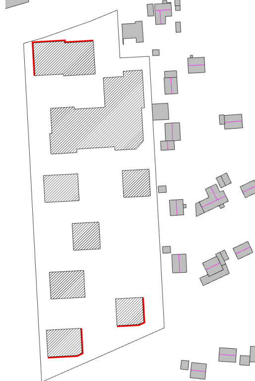
Abbildung 2: Fassaden mit Lärmbelastung größer Lärmpegelbereich II
