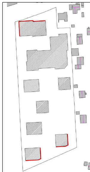
Abbildung 12: Fassaden mit Lärmbelastung größer Lärmpegelbereich II
