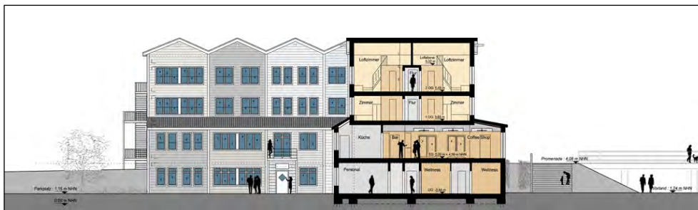
Abbildung 12: Ausnutzung des Höhenunterschiedes zwischen der Seebrückenpromenade am Seebrückenvorplatz und dem Parkplatz am Beispiel des Hotels Bretterbude
