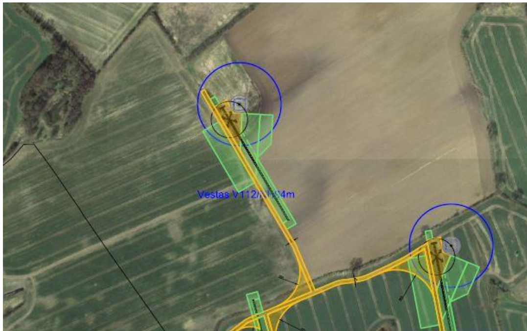
Abbildung 1: Erschließungsflächen für die Anlage in Schönwalde, Auszug aus der Erschließungsplanung von PROKON
